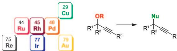
**Ein Platz in der Ruhmeshalle:** Bis kürzlich stand die Titelreaktion im Schatten der katalytischen allylischen Substitution, doch nun wurden für propargyliche Substitutionen effiziente Verfahren entwickelt, die durch verschiedene Übergangsmetalle
